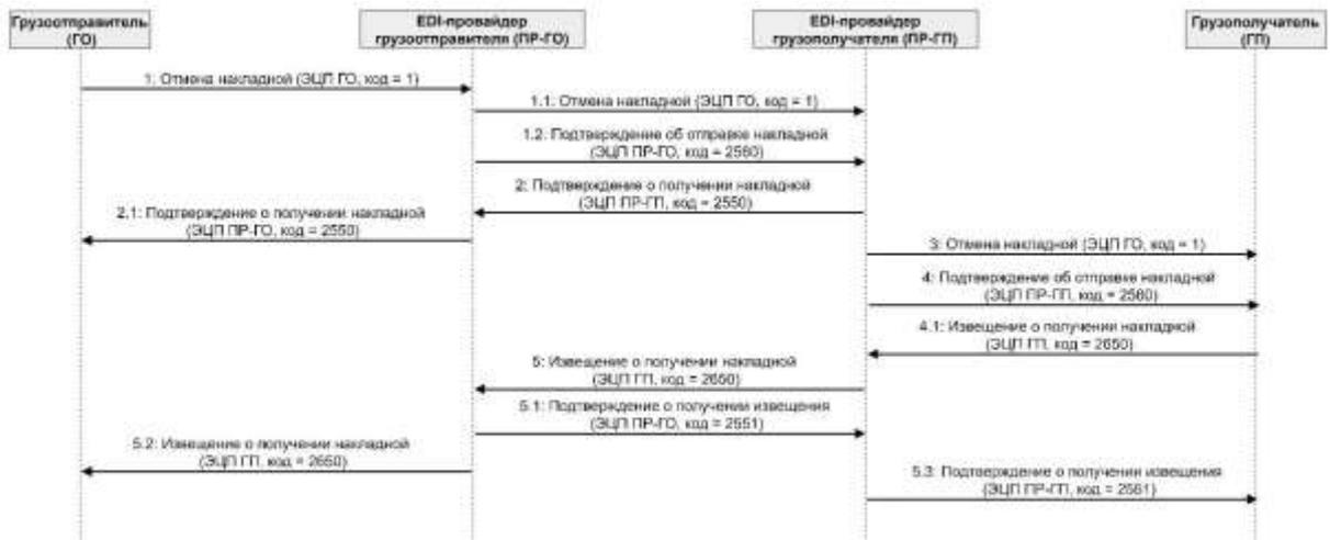
**Рисунок 3.12 - Диаграмма последовательности отмены ЭТН грузоотправителем (два EDI-провайдера)**
