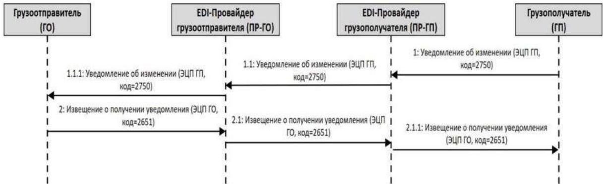
Рисунок 3.11 - Диаграмма последовательности передачи грузополучателем грузоотправителю уведомления об изменении ЭТН (два EDI-провайдера)
