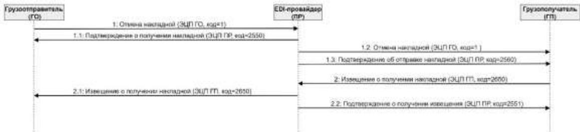
**Рисунок 3.3 - Диаграмма последовательности отмены ЭТТН (один EDI-провайдер)**
